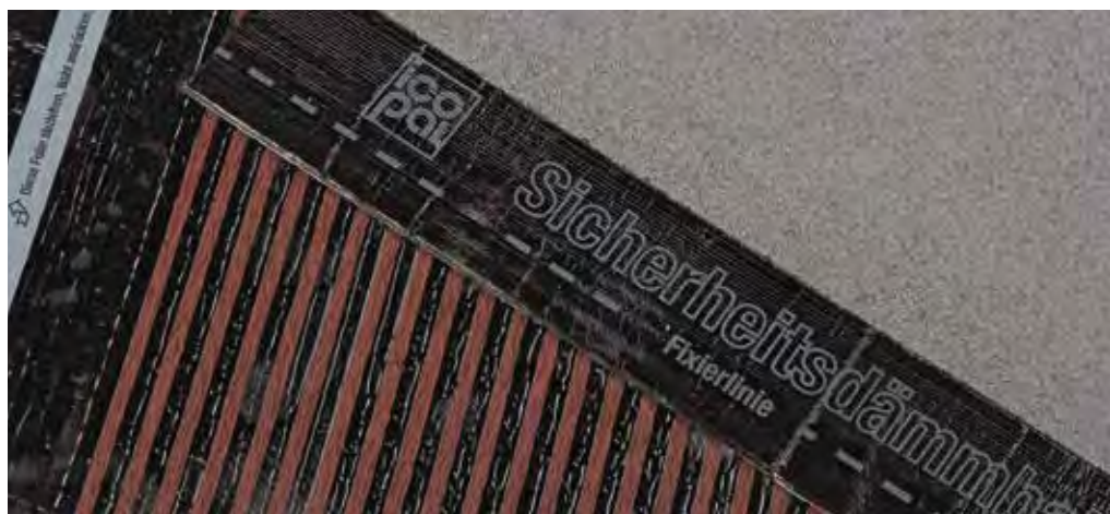
Elastomerbitumenbahn Polar, werkseitig auf den Dämmstoff kaschiert, mit doppelter Icopal Sicherheitsnaht und Power-Therm Streifen
