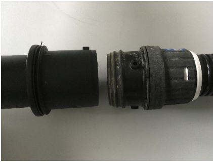
Bild: links Anschlussmuffe Kärcher alt mit Rastnase, rechts Kärcher neu mit drei Rastnasen und geänderter Ausbildung.
